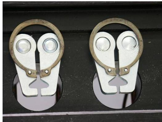
Bild 3: Eingelegte Wellensicherungsringe
